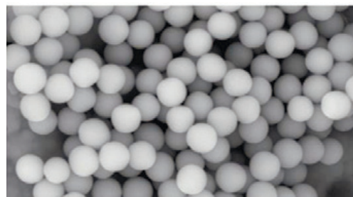
Микросферы диоксида кремния. Ускоряющее напряжение: 10 кВ. Увеличение: 80 000х.
